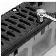
ACO ofrece un sistema de cierre de 4 tornillos ("4 bolt") para aplicaciones que requieren una mayor seguridad. Los cuatro orificios roscados de acero inoxidable en el cuerpo del canal PowerDrain permiten atornillar una rejilla con 4 tornillos por canal para obtener la máxima rigidez y seguridad. También pueden usarse tornillos de seguridad para evitar la manipulación.
