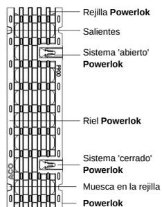
ACO Powerlok es un sistema patentado de fijación de rejilla. Las rejillas son colocadas y removidas con el mínimo de tiempo y esfuerzo para facilitar el mantenimiento.
