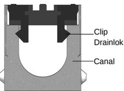
ACO DrainLok™ es un sistema patentado de fijación que elimina la necesidad de barras, tornillos y/o pernos, mejorando la capacidad hidráulica del canal. El mecanismo DrainLok™ simplemente se sujeta internamente al riel del canal para una rápida instalación. Las rejillas ACO DrainLok™ están diseñadas con un mecanismo anti-deslizante que restringe el movimiento indeseado cuando quedan instaladas, mejorando la confiabilidad y durabilidad del sistema.
