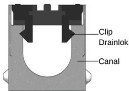
ACO DrainLok™ es un sistema patentado de fijación que elimina la necesidad de barras, tornillos y/o pernos, mejorando la capacidad hidráulica del canal. El mecanismo DrainLok™ simplemente se sujeta internamente al riel del canal para una rápida instalación. Las rejillas ACO DrainLok™ están diseñadas con un mecanismo anti-deslizante que restringe el movimiento indeseado cuando quedan instaladas, mejorando la confiabilidad y durabilidad del sistema.
