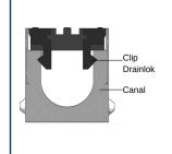
ACO DrainLok™ es un sistema patentado de fijación que elimina la necesidad de barras, tornillos y/o pernos, mejorando la capacidad hidráulica del canal. El mecanismo DrainLok™ simplemente se sujeta internamente al riel del canal para una rápida instalación. Las rejillas ACO DrainLok™están diseñadas con un mecanismo anti-deslizante que restringe el movimiento indeseado cuando quedan instaladas, mejorando la confiabilidad y durabilidad del sistema.
