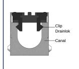
ACO DrainLok™ es un sistema patentado de fijación que elimina la necesidad de barras, tornillos y/o pernos, mejorando la capacidad hidráulica del canal. El mecanismo DrainLok™ simplemente se sujeta internamente al riel del canal para una rápida instalación. Las rejillas ACO DrainLok™están diseñadas con un mecanismo anti-deslizante que restringe el movimiento indeseado cuando quedan instaladas, mejorando la confiabilidad y durabilidad del sistema.
