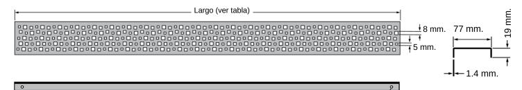
Los conectores de plástico empujados a través del orificio mantienen la rejilla en su lugar.
