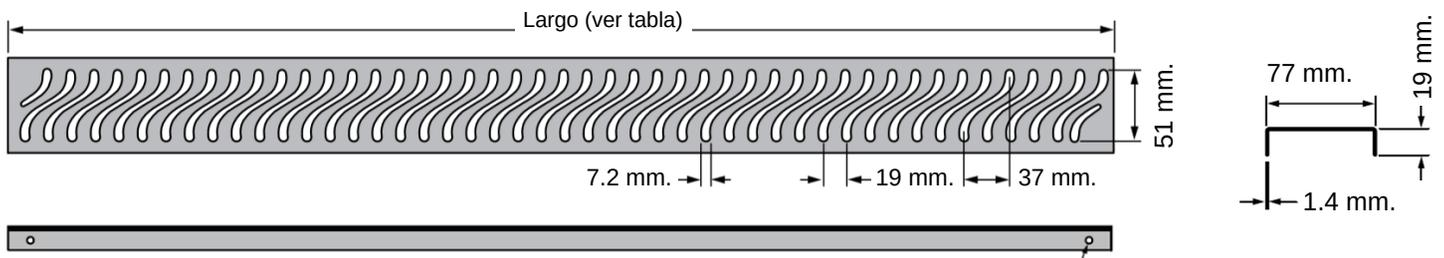
Los conectores de plástico empujados a través del orificio mantienen la rejilla en su lugar.
