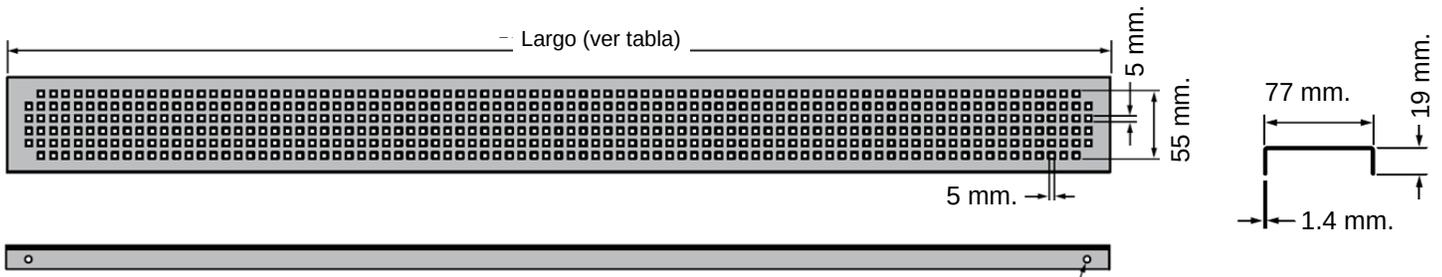
Los conectores de plástico empujados a través del orificio mantienen la rejilla en su lugar.
